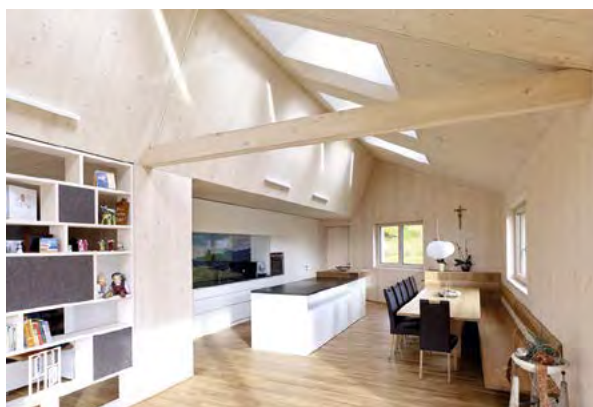
Dům využívá i tzv. zenitové světlo přicházející shora, které je při zatažené obloze třikrát intenzivnější než světlo z bočních oken.
